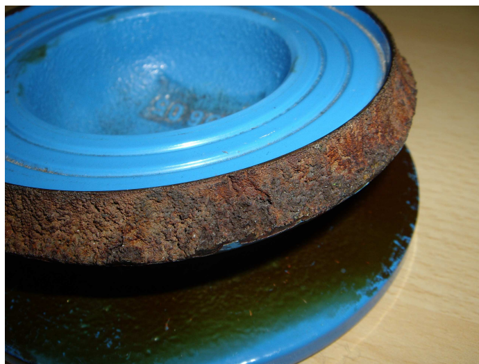
Figure 24 : Élément d'appareil mobile ayant subi le phénomène de cavitation
