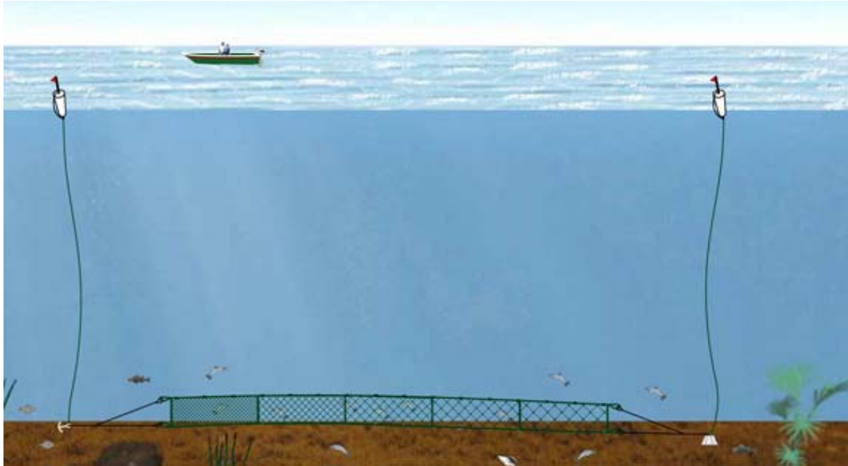
Fig. 18: Représentation d'un filet maillant benthique (filet de fond). www.fipec.qc.ca
