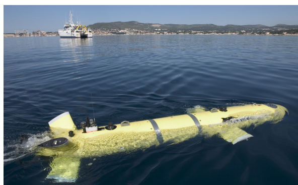
L'AUV Aster ® , engin autonome de reconnaissance et de surveillance des fonds marins ou de la colonne d'eau.
