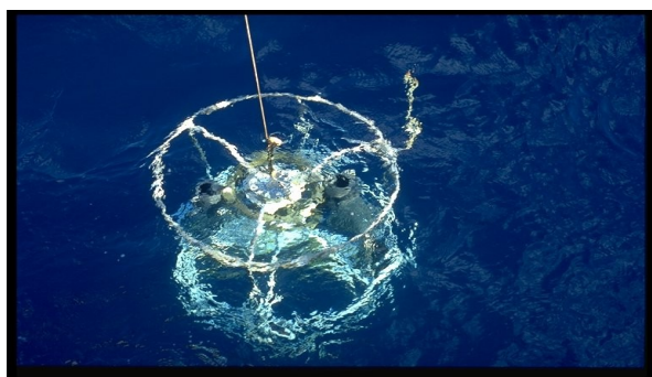
Mise à l'eau d'une rosette bathysonde destinée au prélèvement d'eau de mer à différentes profondeurs. ©Ifremer/Olivier Dugornay
