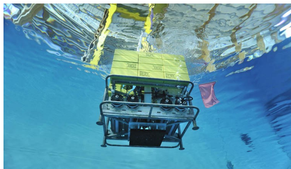
BOB, module destiné à la surveillance des sorties de bulles de gaz en fond de mer, en test au bassin d'essais du Centre Ifremer Bretagne.
