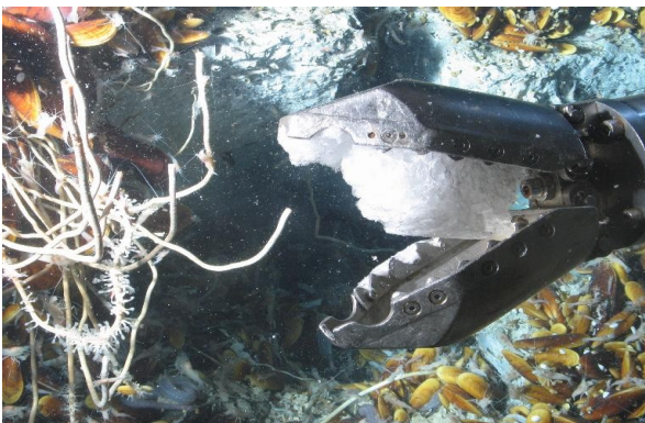
La pince du ROV Victor 6000 (robot téléopéré de l'Ifremer) contenant une bouchée d'hydrate de gaz
