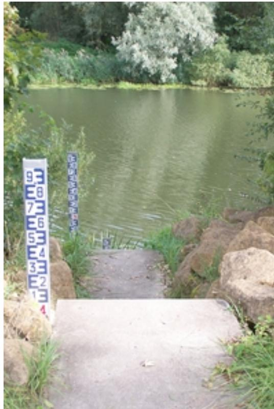
Figure 52 : échelle limnimétrique
