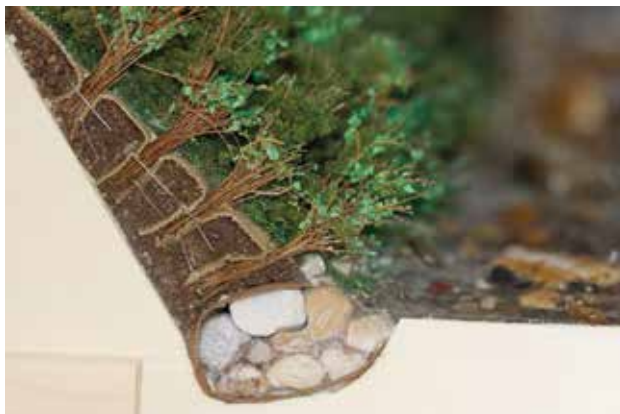
Fig. 4 - Maquette pédagogique : lits de plants et plançons et enrochement de pied.
