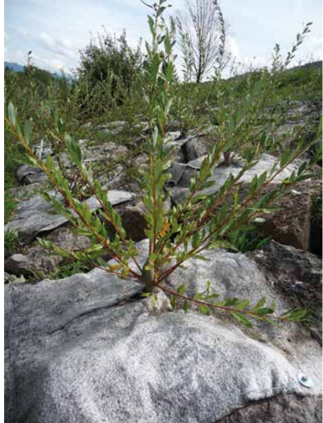
Fig. 71 - Placette n° 1 : développement d'un pieu de saule faux daphné en août de la première saison de végétation.
