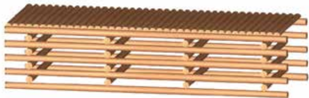
Fig. 32 - Platelage avec rondins refendus sur la longueur et disposés dans le même sens.
