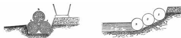
Fig. 5 - Stabilisation des berges de la Broye au moyen de fascines à noyau, selon le système de Gumpfenberg (ingénieur en Bavière), vers 1865 (Vischer 2003).
