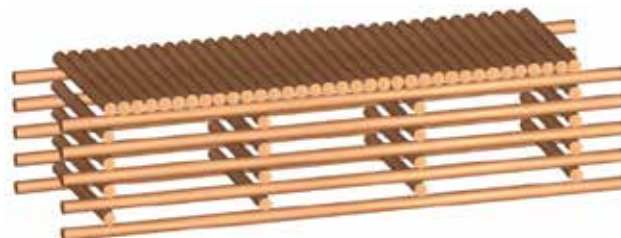
Fig. 33 - Platelage avec rondins entiers disposés côte à côte.
