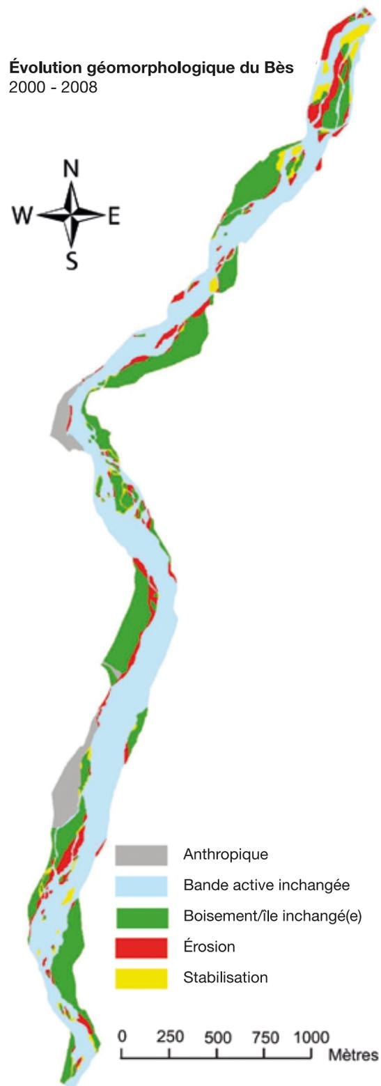
**Fig. 10** - Cartographie de la recharge par sapement de berge sur le Bès (Alpes-de-Haute-Provence - France) entre 2000 et 2008 à partir de la comparaison d'une orthophotographie et d'un levé LiDAR aéroporté (Genin 2009).
