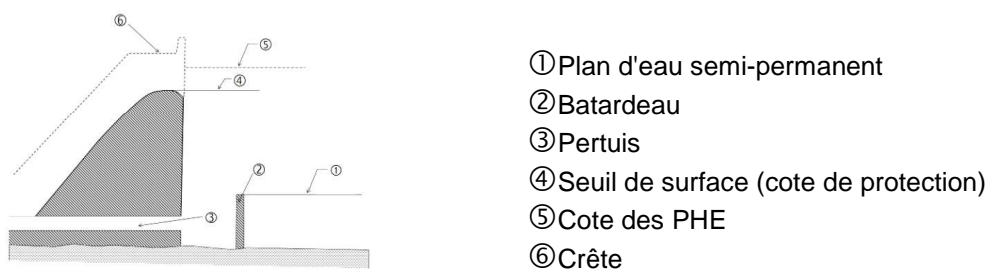
Figure 1.1 – Coupe schématique d'un barrage écrêteur de crues
