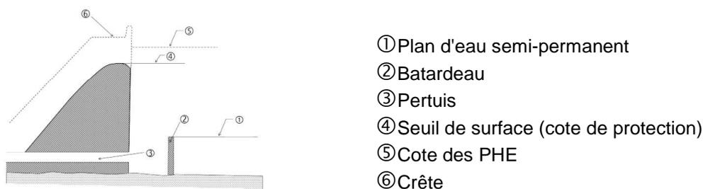
Figure 1.1 – Coupe schématique d'un barrage écrêteur de crues
