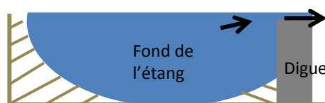
Figure 4 : Système de déversoir de surface (source personnelle)
