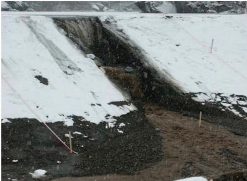
Figure 14. *Projet Impact (2002) : phase de headcutting précédant la défaillance du parement côté rivière sur une digue de 5 m de haut*
