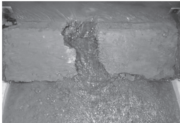
Figure 10. T=9 h, phase d'élargissement rapide de la brèche
