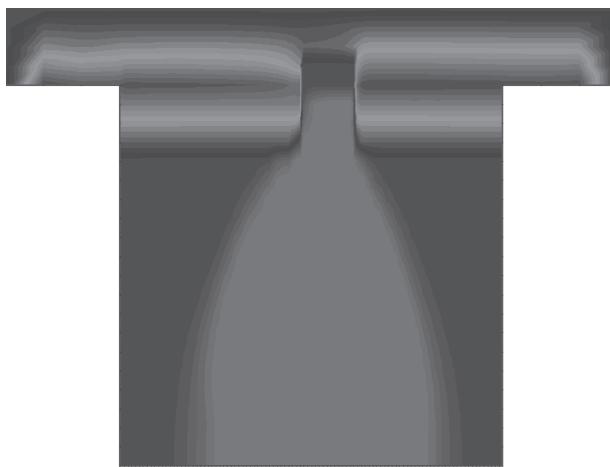
Figure 19. Fosse d'érosion asymétrique créée à l'amont de la brèche
