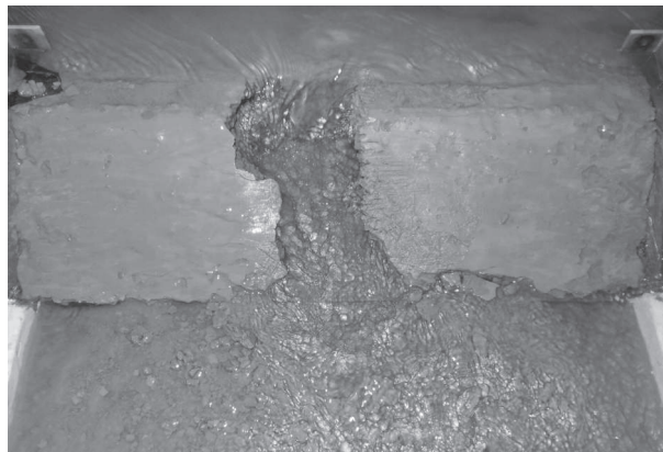
Figure 11. Allure de la brèche et du jet sortant au moment de l'arrêt de l'essai
