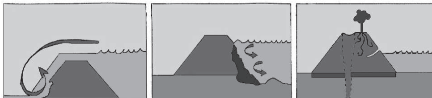
Figure 1. Les différents types de dégradations des digues fluviale de protection.
