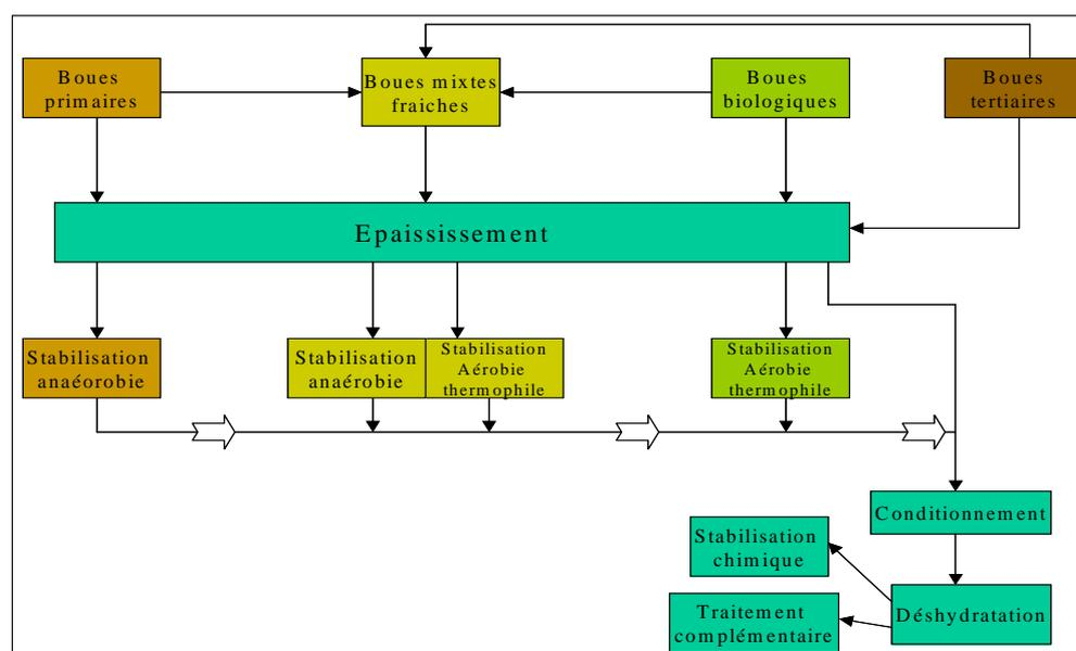
*Figure 2. Schéma général des traitements des boues.*
