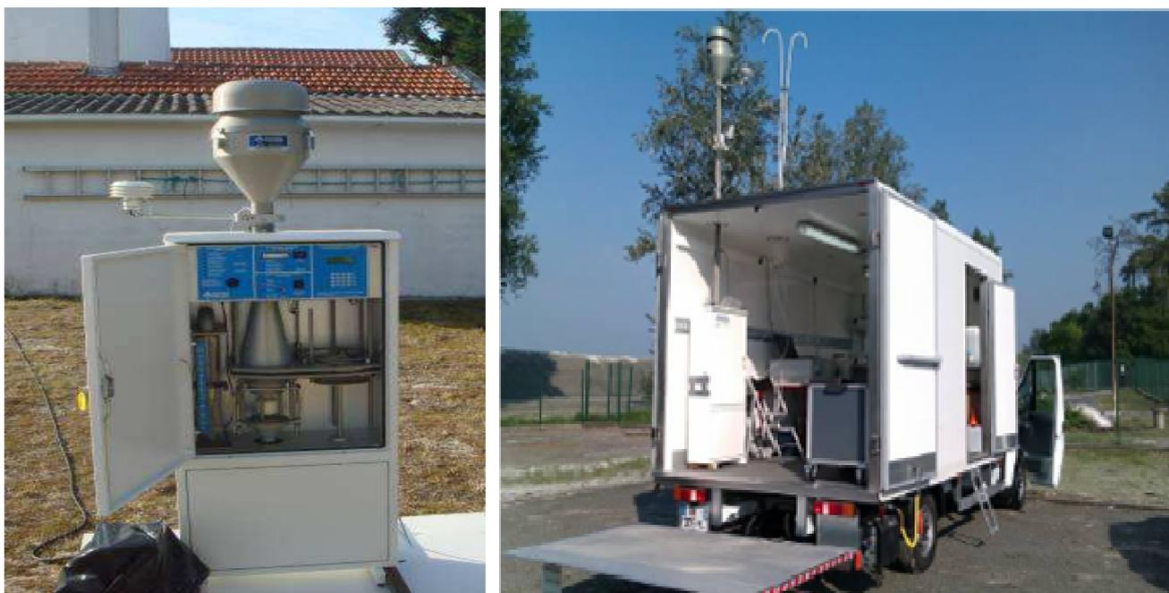
**Figure 6. : Préleveur de particules atmosphériques à haut débit et Camion laboratoire mobile Barracuda.**
