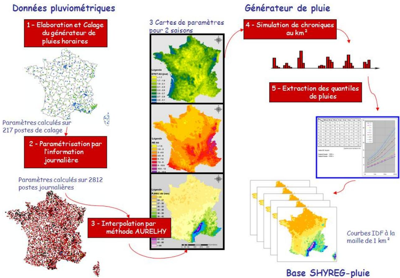
Figure 1 : Principe de l'élaboration de la base SHYREG-pluie
