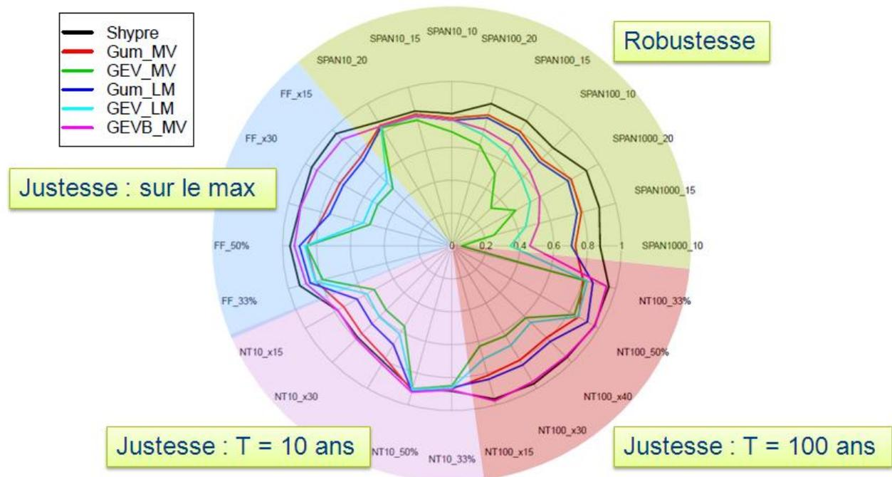
Figure 9 : Exemple de résultats du projet ARN Extraflo de comparaison de méthode de prédétermination de crue : critères de justesse et de robustesse des méthodes locales d'estimation des débits : méthode SHYREG et ajustement de lois (GEV et Gumbel) par différentes méthodes (MV =maximum de vraisemblance et LM = L-moments).
