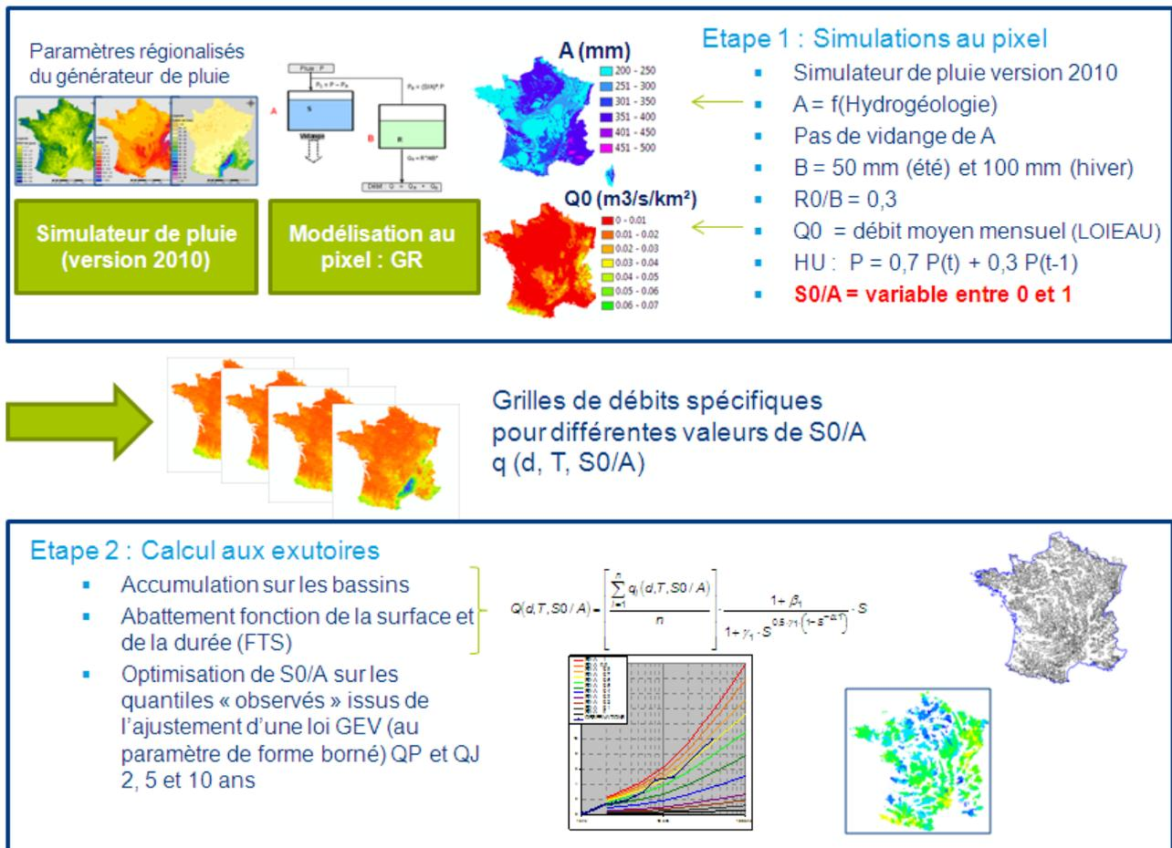
Figure 2 : Principe du calage de la méthode SHYREG-débit
