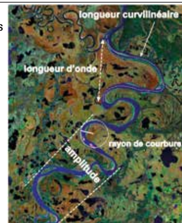
Fig. 14 - Principaux indices morphométriques utilisés pour caractériser la forme des méandres. L'amplitude est souvent utilisée dans la délimitation de l'espace de mobilité.
