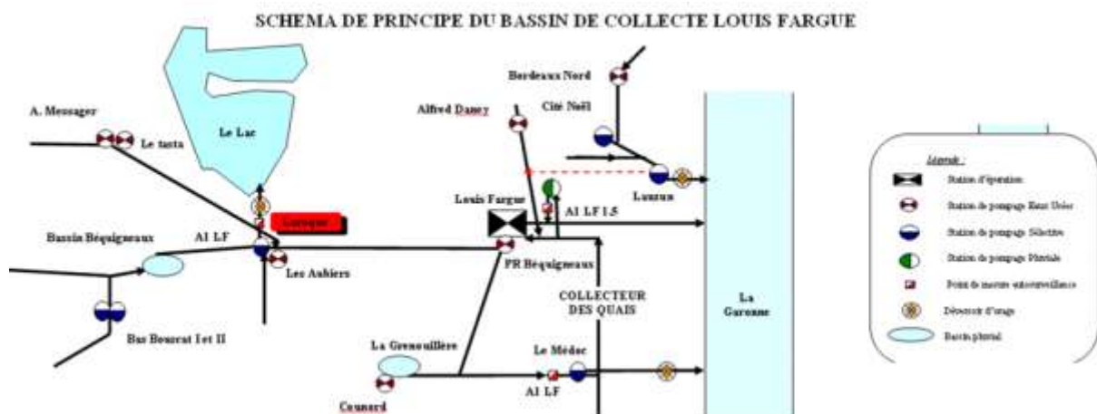
Figure 48 : une partie du schéma de principe du bassin de collecte de Louis Fargue (Note de fonctionnement Lyonnaise des Eaux, 2007).
