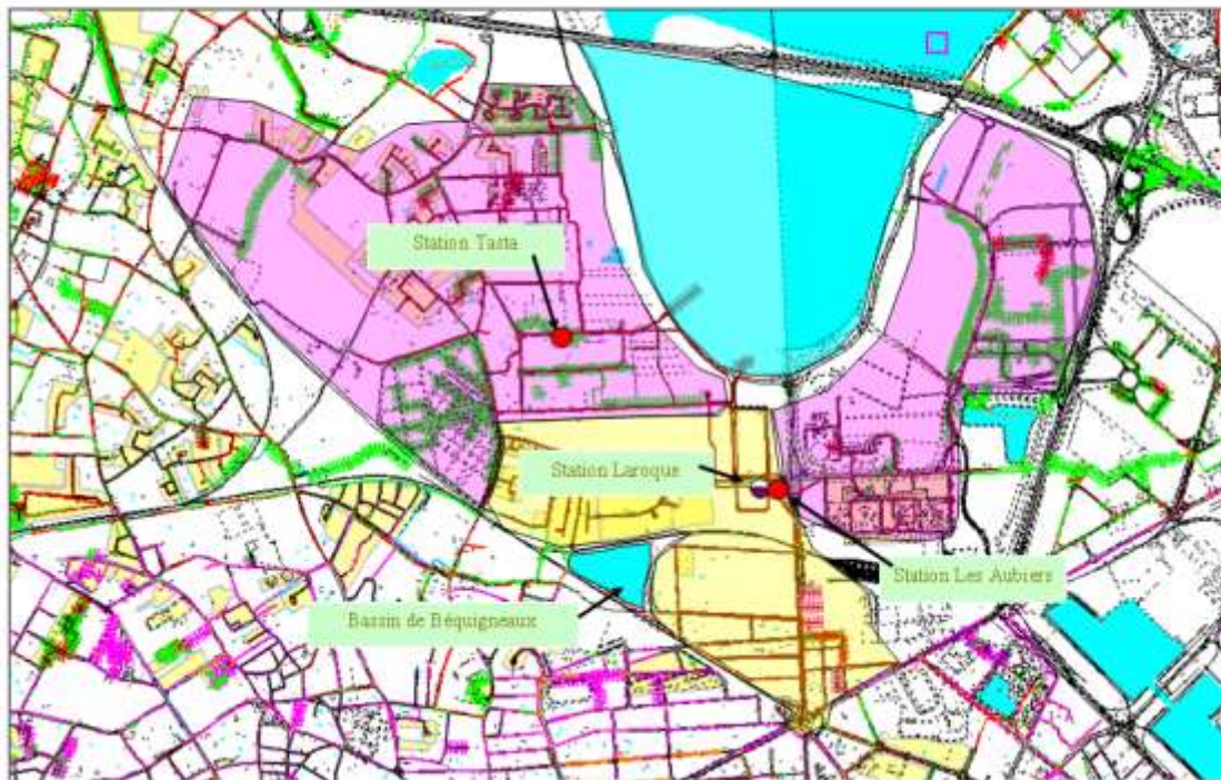
Figure 47 : zoom des zones d'eaux usées du Tasta et des Aubiers envoyées vers la station de pompage de Laroque (Note de fonctionnement Lyonnaise des Eaux, 2007).
