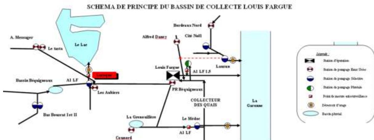
Figure 48 : une partie du schéma de principe du bassin de collecte de Louis Fargue (Note de fonctionnement Lyonnaise des Eaux, 2007).
