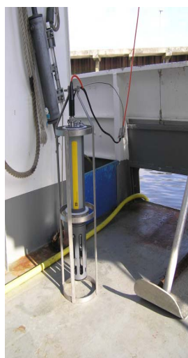
Figure 12: La sonde multiparamètres YSI (à gauche) et le cadre arrière avant son immersion (à droite).
