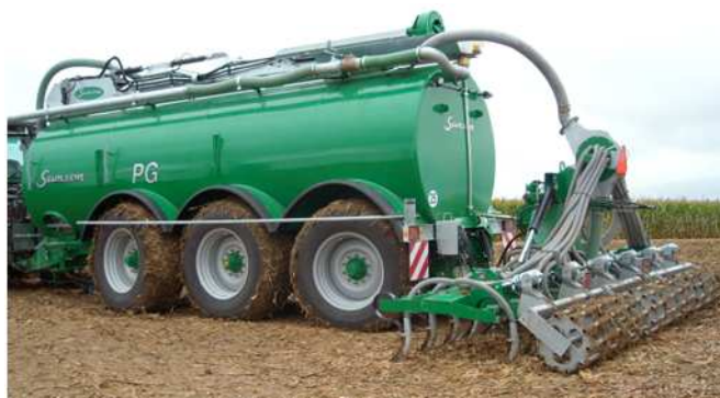
Photo 3 : Une tonne à lisier de grande capacité avec enfouisseur, [J. Mazoyer, Irstea]
