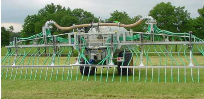
Photo 4 : Tonne à lisier avec rampe à pendillards, [P. Lépée, Ch. Agri. de la Creuse]
