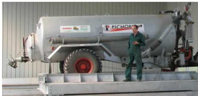
Photo 5 : Tonne à lisier avec une buse unique, [M. Rousselet, Cemagref]
