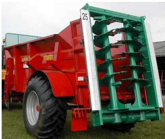
Photo 1 : Un épandeur standard à 2 hérissons verticaux [J. Mazoyer, Irstea]
