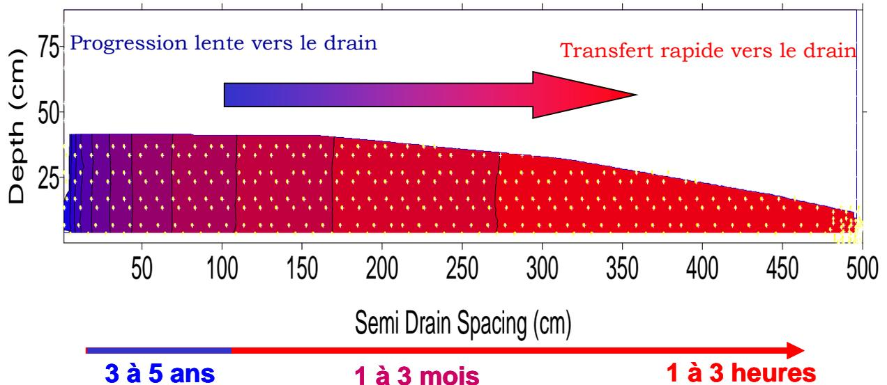
*Figure 2: Schéma de la répartition des temps de transfert en parcelle drainée type sur la base d'un écartement des drains de 10 m, une profondeur des drains de 90 cm et un volume annuel moyen drainé de 200 mm (moyenne calculée de 1986 à 2003).*
