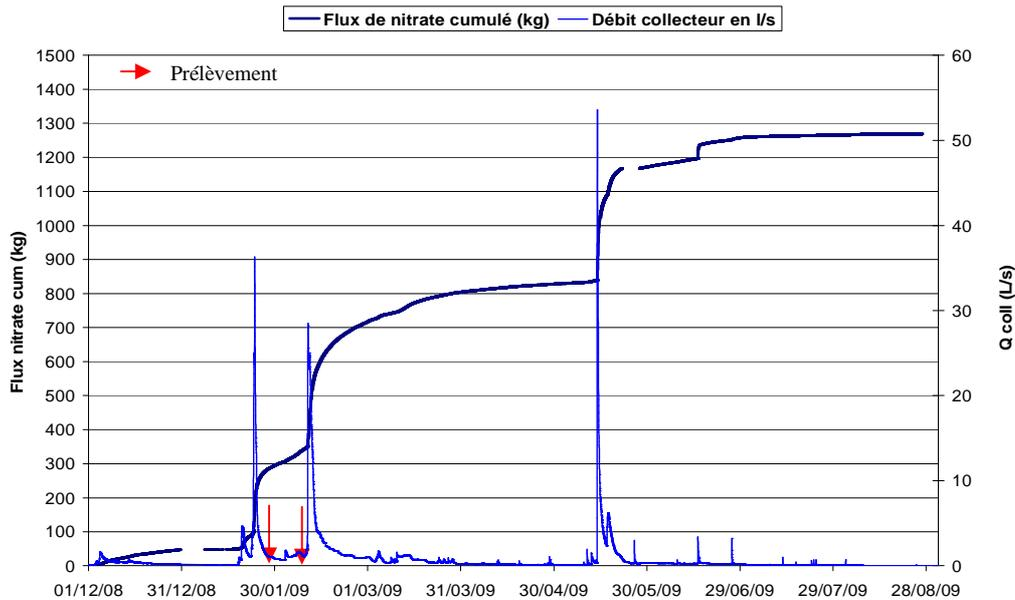
**Figure 3: Chronique des écoulements de drainage mesurés sur parcelle drainée (BV Orgeval, données GIS ORACLE).**
