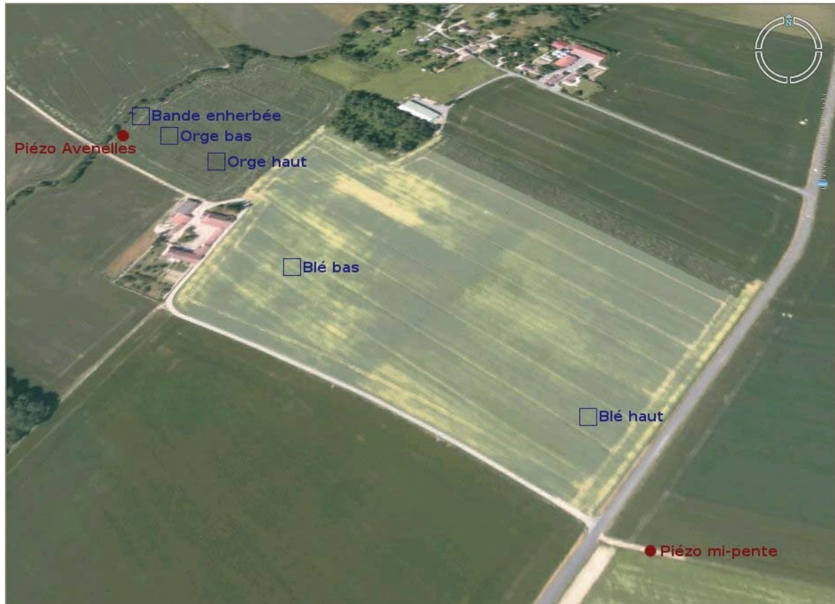
Figure 4 : Emplacement des chambres de mesures des émissions de N 2 O (par accumulation du gaz au cours du temps cf. texte)
