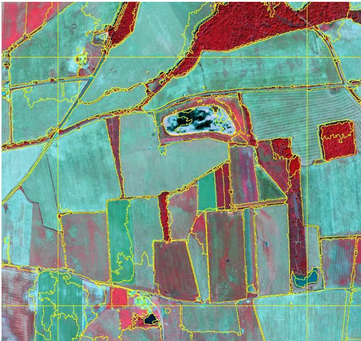
Figure 7. Segmentation IGN niveau 1 (en jaune) sur le fond IRC IGN. Le parcellaire agricole est bien délimité, on observe cependant des artéfacts dus à la segmentation par dalles (cf. lignes horizontales et verticales sur bords de la figure).
