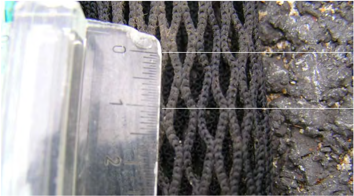
Maillage du petit chalut à perche utilisé au cul du chalut (10 mm étirées)
