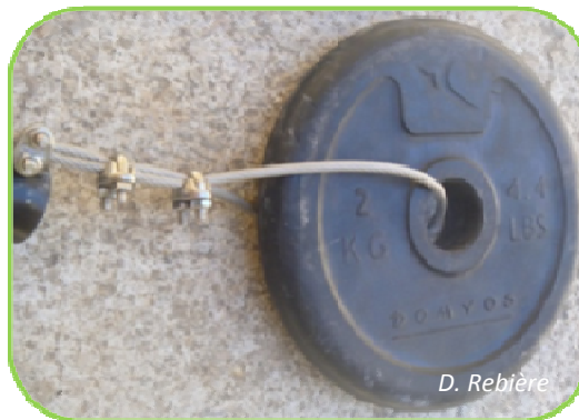
Figure 14. Montage du lest sur le câble
