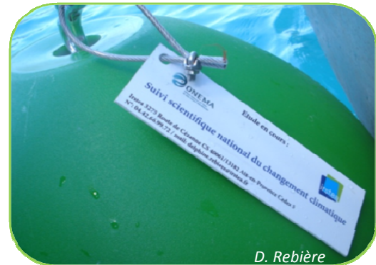
Figure 10. Panneau informatif en pvc fixé sur la bouée (L: 220 mm, h: 100 mm)
