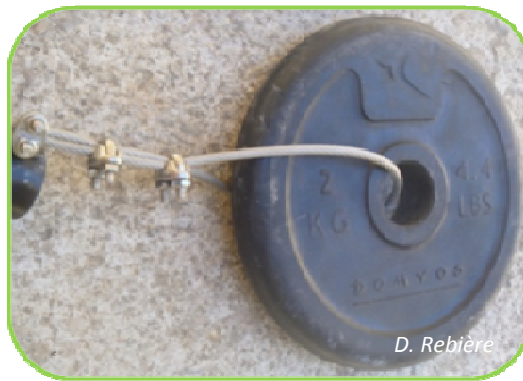
Figure 14. Montage du lest sur le câble
