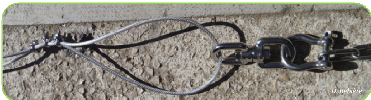
Figure 11. Montage de l'ensemble émerillon + manille pour ajouter de la chaîne au câble A
