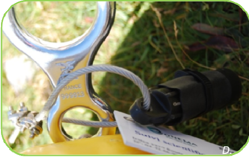
Figure 12. Montage du premier enregistreur sur la bouée dans le cas de mouillage de sub-surface
