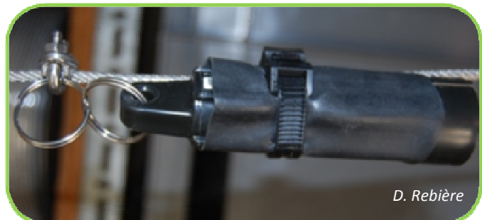
Figure 15. Enregistreur de température fixé sur le câble B équipé avec 1 anneau brisé (à droite nu avec 2 anneaux brisés)
