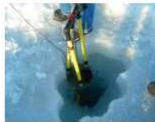
Profiléur avec protection anti collision
