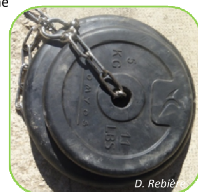
Figure 17. Photo d'un corps mort pour le mouillage des enregistreurs de température
