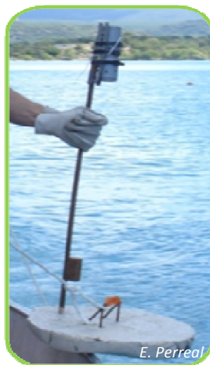
Figure 20. Capteur de pression fixé sur un corps mort en béton
