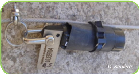
Figure 15. Enregistreur de température fixé sur le câble B équipé avec 1 anneau brisé (à droite nu avec 2 anneaux brisés)
