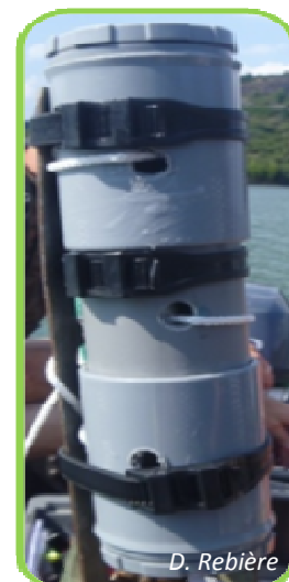
Figure 21. Montage du tube pvc sur une tige de fer à béton pour contenir le capteur de pression
