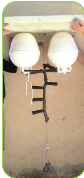
Figure 26. Photo du dispositif pour suivre la température de surface sur le lac de Bimont (13) du 15/05/2013 à 00:00 (UTC) jusqu'au 04/06/2013 à 7:55 (UTC)
