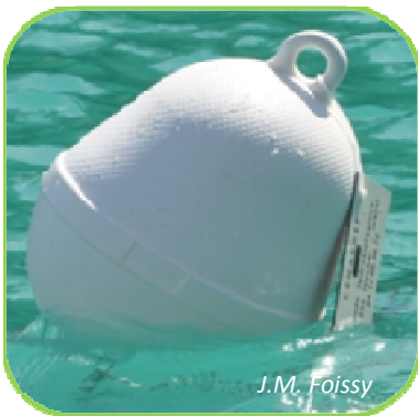
Figure 19. Bouée équipée d'un panneau informatif pour le mouillage du capteur de pression
