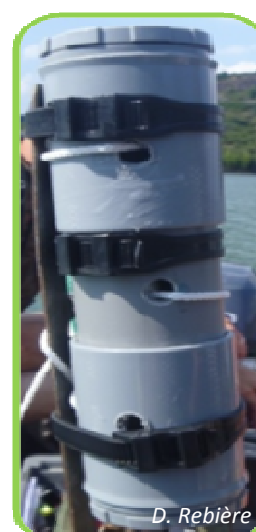
Figure 21. Montage du tube pvc sur une tige de fer à béton pour contenir le capteur de pression
