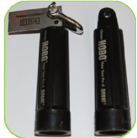
Figure 2. Enregistreurs de température Hobo équipé à gauche d'une plaquette informative et d'une manille en inox et à droite un enregistreur « nu ». Le capteur de température se trouve à l'extrémité haute entre le bord et le trou d'attache
