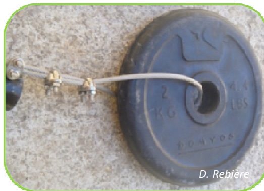
Figure 14. Montage du lest sur le câble
