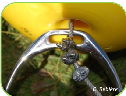
Figure 9. Attache des 2 brins de câble au niveau de l'œil de l'étrier sous la bouée
