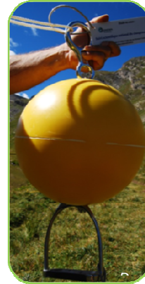
Figure 8. Dispositif pour fixer les câbles A et B sur les bouées disposant d'une cheminée centrale
