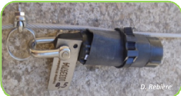
Figure 15. Enregistreur de température fixé sur le câble B équipé avec 1 anneau brisé (à droite nu avec 2 anneaux brisés)
