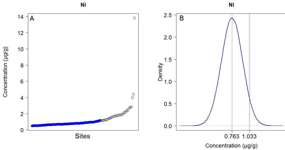
**Figure 19.** Valeur seuil déterminée pour Ni. En pointillé : BBC (moyenne), en tiret : BBAC (95<sup>e</sup> percentile). Les valeurs sont données en µg/g (poids sec). LQ = 0.477 µg/g (ps)
