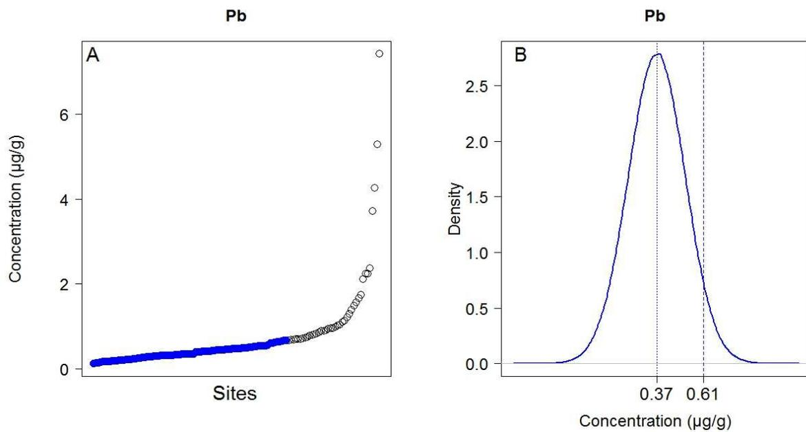
**Figure 20.** Valeur seuil déterminée pour Pb. En pointillé : BBC (moyenne), en tiret : BBAC (95<sup>e</sup> percentile). Les valeurs sont données en µg/g (poids sec). LQ = 0.095 µg/g (ps)
