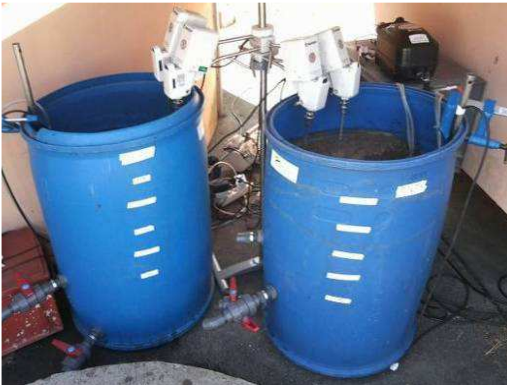
Figure 3 : Photographie des deux réacteurs fermés (à gauche le réacteur aérobie agité et aéré ; à droite le réacteur anoxie agité et non aéré)
