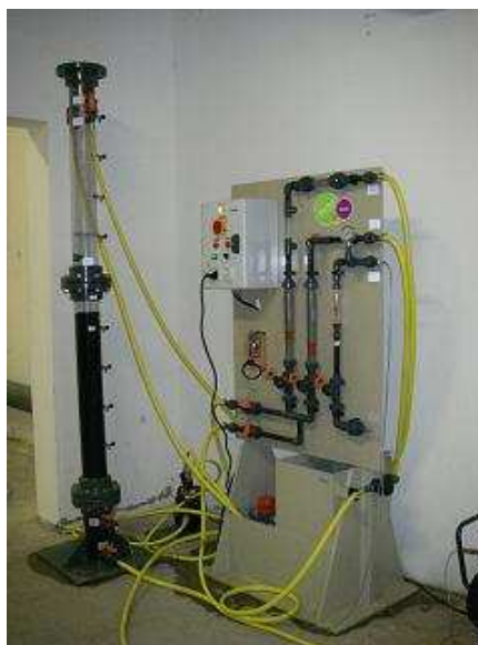
Figure 2 : Colonne de charbon actif avec sa panoplie sur le site A w
