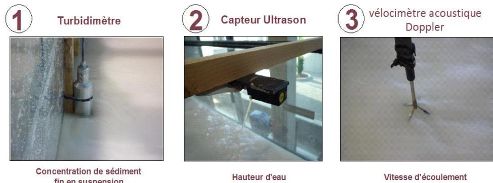
Figure 5: Capteurs utilisés dans le montage expérimental dans le canal incliné
