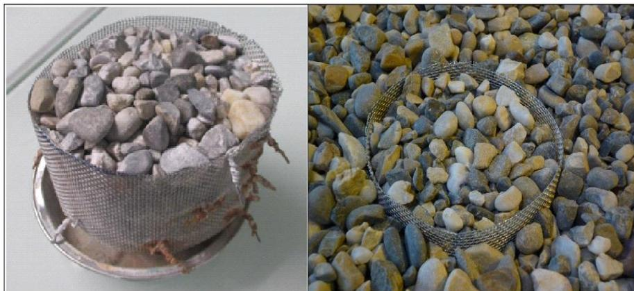
Figure 26: Piège de sédiment fin cylindrique (gauche), Cylindre enterré dans le lit de gravier du canal (droite)
