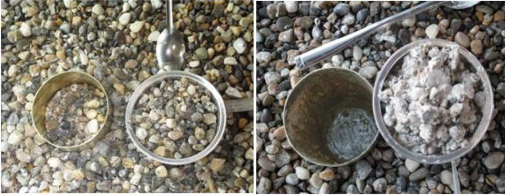
Figure 29: Vue des échantillons pris par la méthode du tuyau enfoncé
