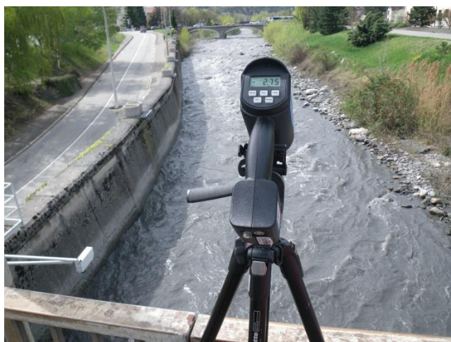
Figure : Photo de l'Arvan vue du pont vers l'amont avec installation du radar SVR (Fabien Thollet)
