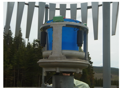
FIGURE 3.6 – Précipitomètre à pesée de la Station Principale
