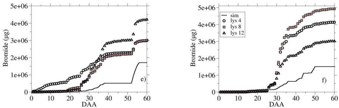
**Figure 5 :** Flux de bromure cumulé (observé en point) sur les 3 lysimètres et simulé (continu) en 2002-2003 (e) et 2003-2004(f) en fonction des jours après traitement (DAA)
