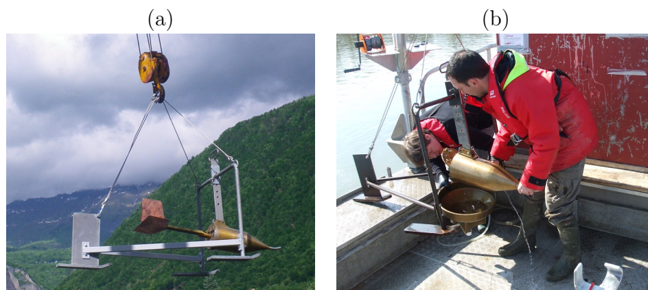
FIGURE 2.15 – Bouteille de Delft avec sa structure, (a) suspendue avant mise à l'eau (Photo M. Courtel) et (b) sur le bateau pour la récupération des sédiments (Photo S. Rodrigues).
