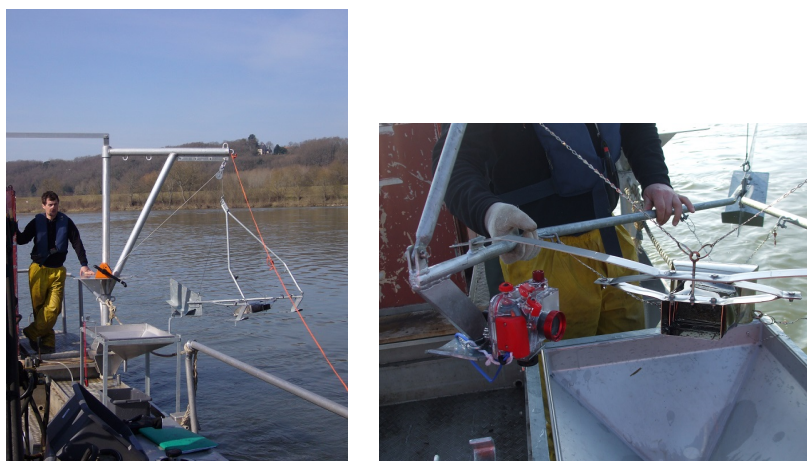
FIGURE 2.3 – Préleveur BTMA (a) avant immersion (b) avec le dispositif caméra (Photos S. Rodrigues).
