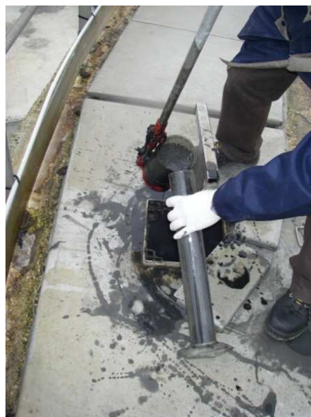
Figure 10 : Prélèvement de boue liquide à l'aide d'une canne munie d'un béccher en verre
