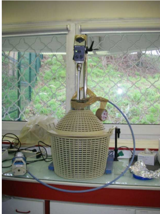
Figure 11 : Bonbonne en verre munie d'un agitateur téflon pour l'homogénéisation des prélèvements de boue liquide
