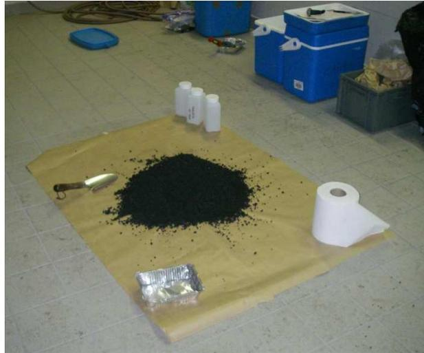
**Figure 7 : Prélèvements de boue avant quartage**
