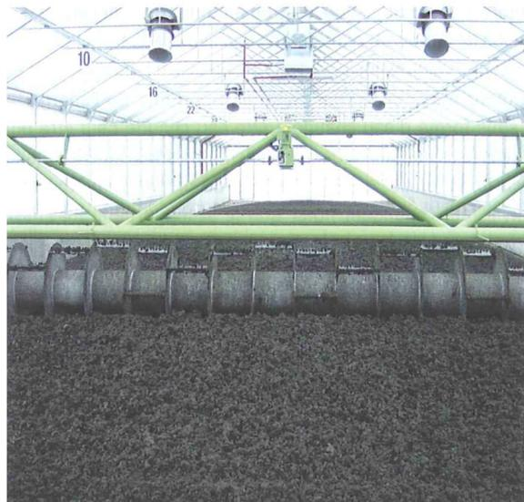
Figure 4 : Scarificateur en fonctionnement dans une serre
