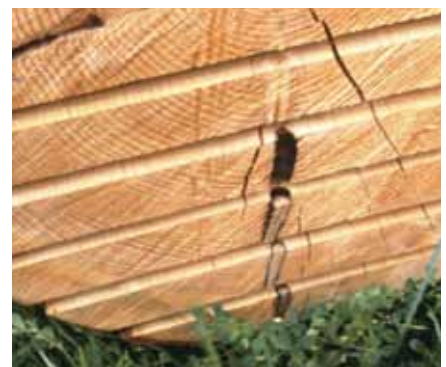
40 - L'absence d'élagage laisse des nœuds qui déprécient la qualité du bois (ici une branche ayant donné un nœud non adhérent dans les plateaux les plus externes).
