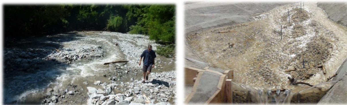
Figure 22 : Faciès de tressage observés dans des plages de dépôt : sur le terrain (cru du torrent des Moulins – Epierre - Savoie France– 2013) et modèle physique du Chagnon (Koulinski et al. 2011)
