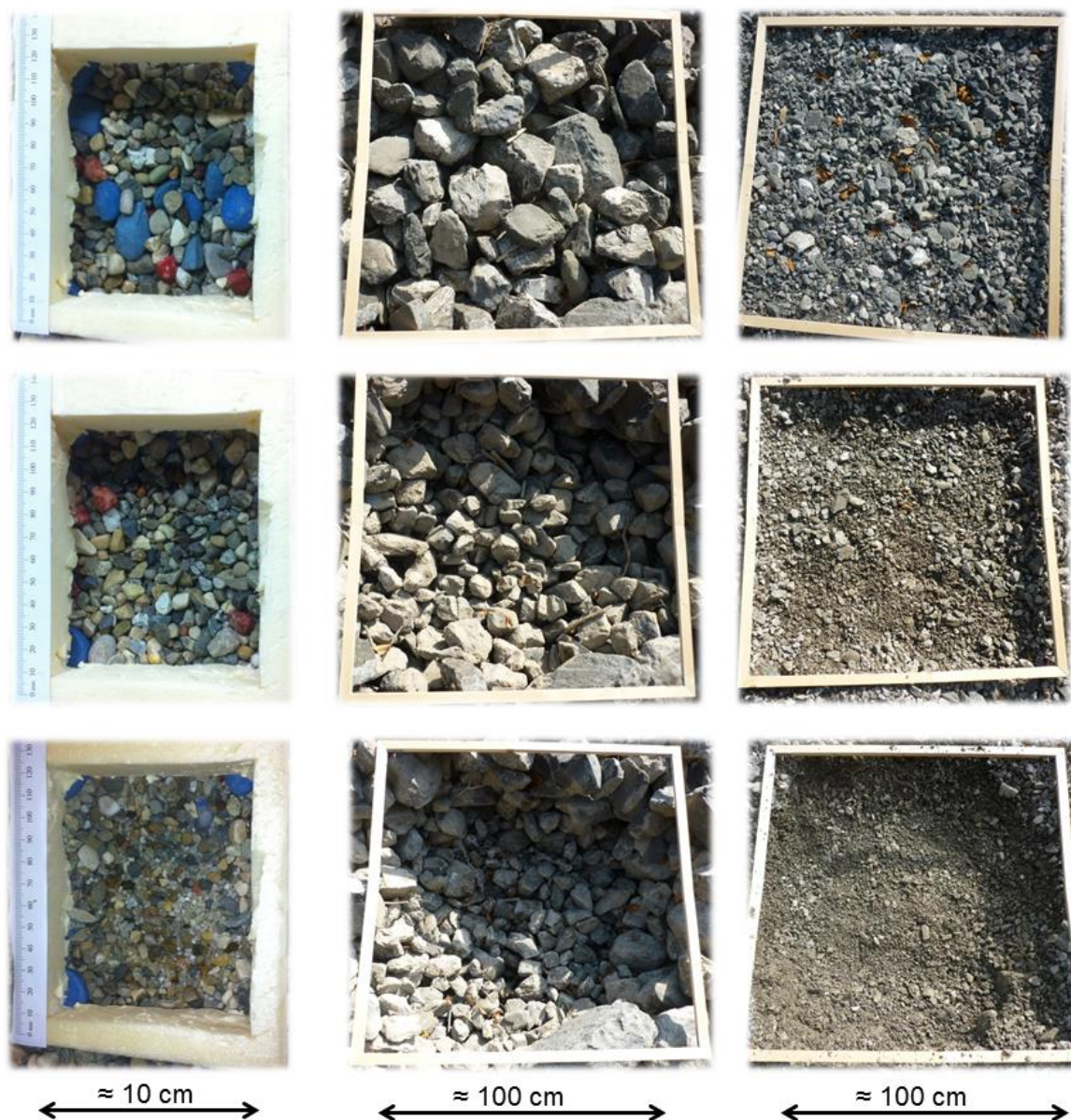
Figure 9 : Tri granulométrique vertical sur des zones de dépôt : mesures de laboratoires et mesures de terrain sur le torrent du Manival (Isère, France) : résultats similaires de présence des éléments grossiers sur le dessus du dépôt et de percolation des plus fins au cours du transport, manifestation probable de tri cinématique (Bacchi 2011; Bacchi et al. 2014; Recking 2006), clichés tirés de (Le Guern et al. 2014)
