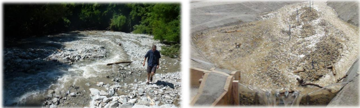
Figure 22 : Faciès de tressage observés dans des plages de dépôt : sur le terrain (crue du torrent des Moulins – Epierre - Savoie France– 2013) et modèle physique du Chagnon (Koulinski et al. 2011)
