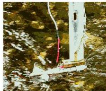
Pour une gamme de vitesse déterminée, la courbe d'étalonnage est sensiblement linéaire. Pour une hélice donnée, on aura donc une ou plusieurs droites d'équation de la forme suivante :
