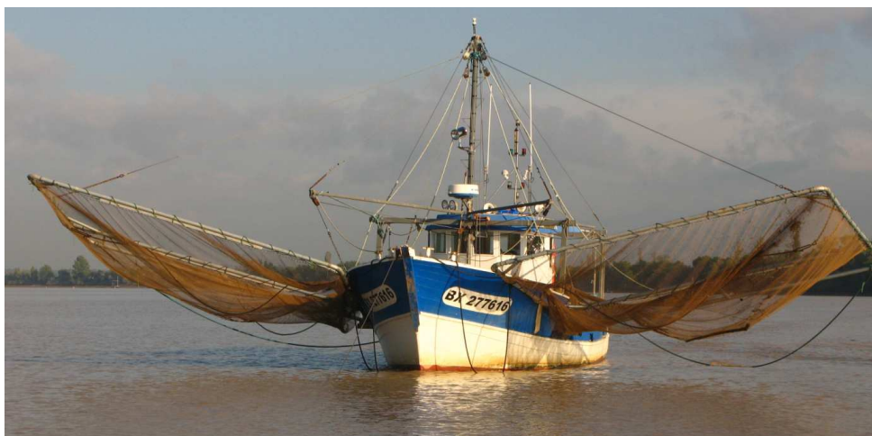
Figure 1 : Le navire de pêche équipé de 2 haveneaux
