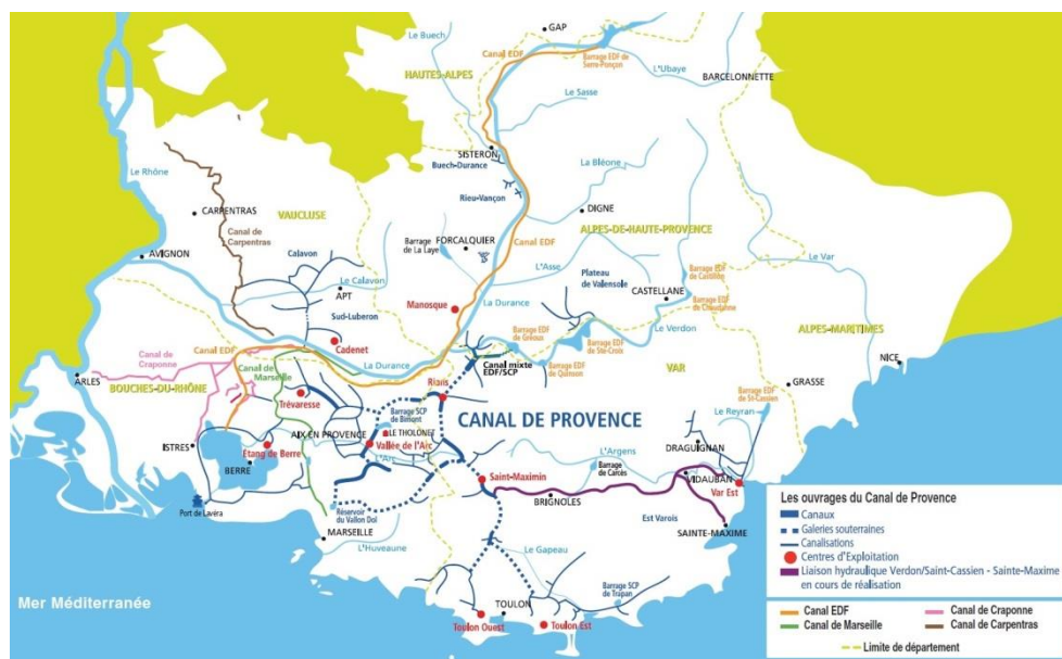
Figure 19 : Carte des principaux aménagements du système Durance-Verdon (Source : Société du Canal de Provence)
