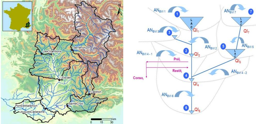
Figure 51 : Schéma de principe de la modélisation intégrée de la gestion sur le bassin –  $AN_{BVI\ i}$  désigne les apports naturels du sous-bassin  $i$ , et  $Q_i$  le débit influencé à l'exutoire du bassin versant  $i$ , les LACs sont les trois retenues modélisées,  $Prél_i$ ,  $Restit_i$ , et  $Conso_i$  sont les prélèvements, restitutions au milieu et consommation associé au secteur  $i$
