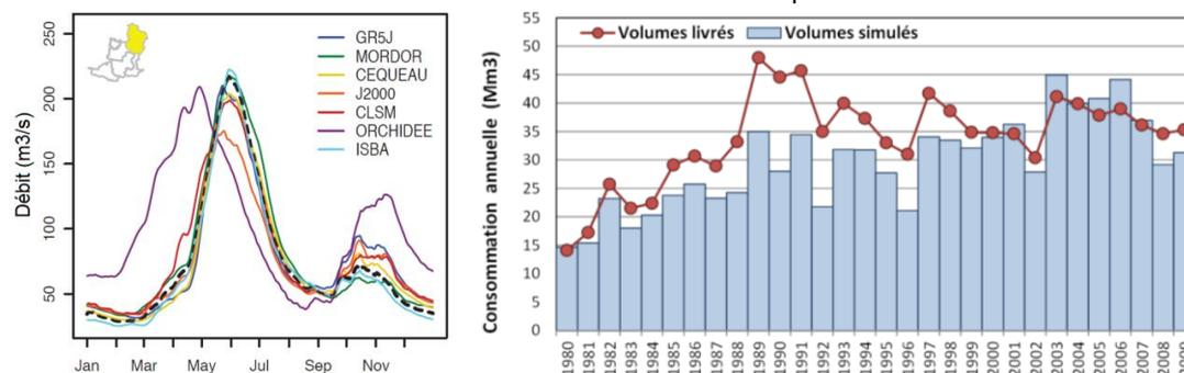
Figure 3 : Résultats de simulation des outils mobilisés dans R<sup>2</sup>D<sup>2</sup> 2050, à gauche les débits décennaux moyens interannuels observés et simulés pour la Durance à Serre-Ponçon, à droite les consommations annuelles en eau d'irrigation simulées par FIVE-CoRe et livrées sur le périmètre desservi par la SCP
