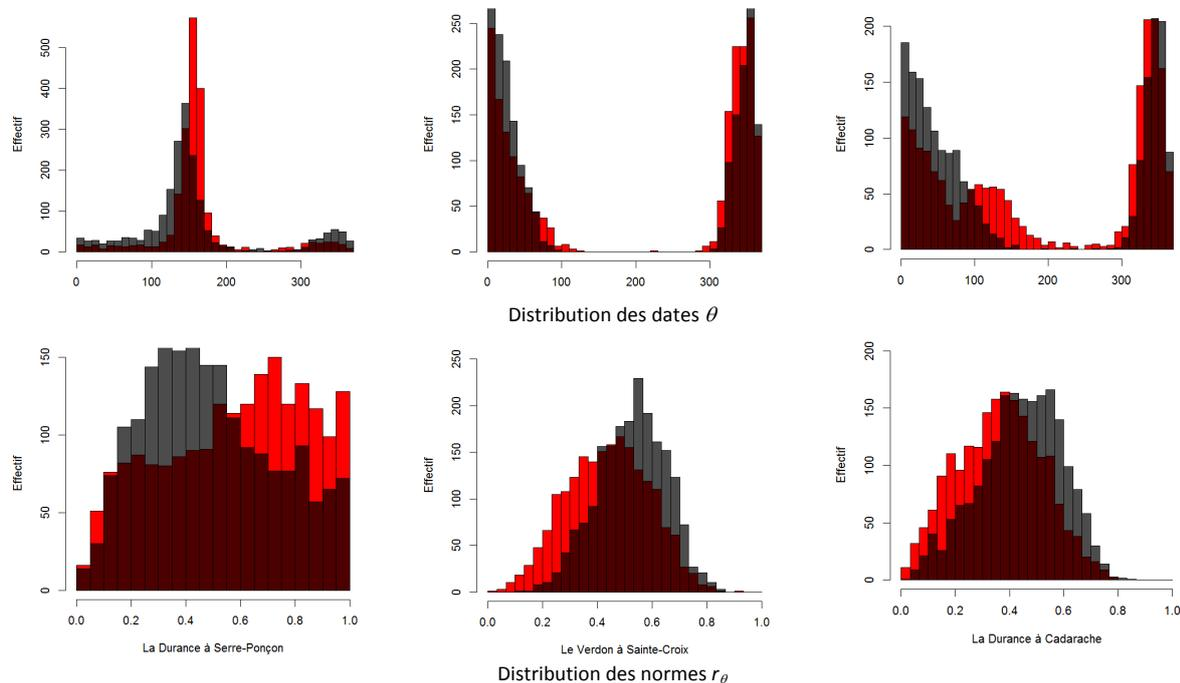
Figure 70 : Distribution des normes  $r_\theta$  et des dates  $\theta$  - en rouge, basée sur l'ensemble des simulations GCM/MDES/MH en temps présent, en gris, basée sur l'ensemble des simulations GCM/MDES/MH en temps futur
