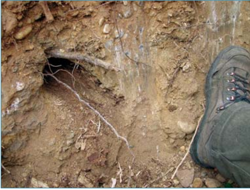
Figure 1.22. Galerie laissée en place par une racine décomposée de peuplier (10 cm de diamètre) dans des matériaux cohésifs (matrice limoneuse). De nouvelles racines empruntent ce chemin privilégié (ph.C. Zanetti)
