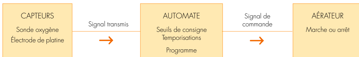
Figure III.3. – Chaîne d'automatisation par asservissement ou régulation
