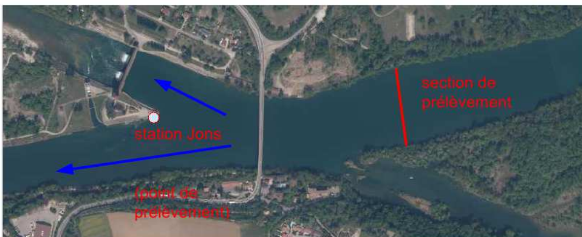
Figure 11 : Localisation de la section de prélèvements pour le contrôle de l'homogénéité des concentrations en MES dans le Rhône à Jons.
