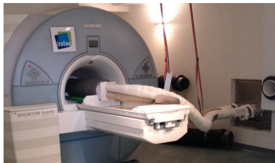
FIGURE 1 – IRM Siemens avec un four pour l'étude de la cuisson du pain
