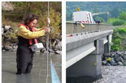
Jaugeage au courantomètre (Incertitude ~ 7 à 15 %)
