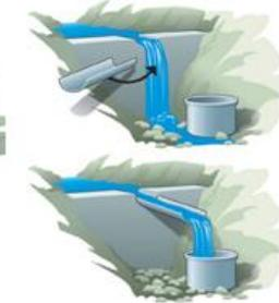
Jaugeage capacitif par mesure du temps de remplissage d'un seau
