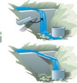
Jaugeage capacitif par mesure du temps de remplissage d'un seau (Incertitude ~ 5 à 10 %)
