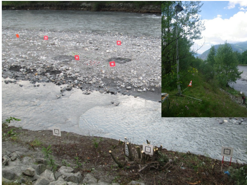
Figure 6 : Photo du dispositif pour l'analyse vidéo LSPIV (en encart la photo du mat sur lequel est positionnée la caméra).
