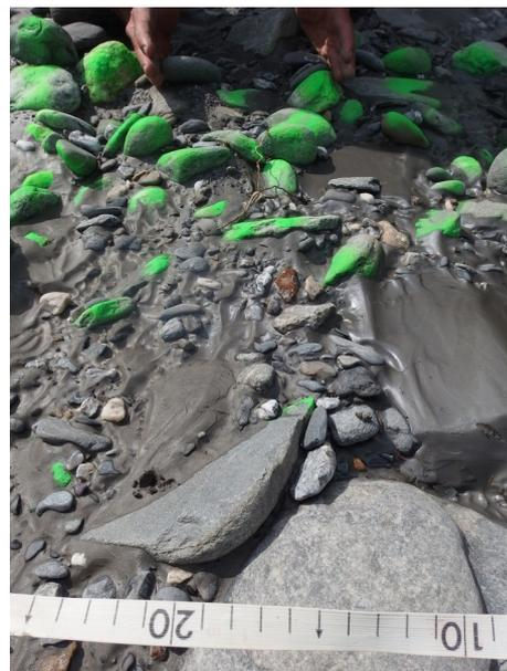
Figure 33 : Photos de surface des 4 placettes de la tranchée après la chasse.
